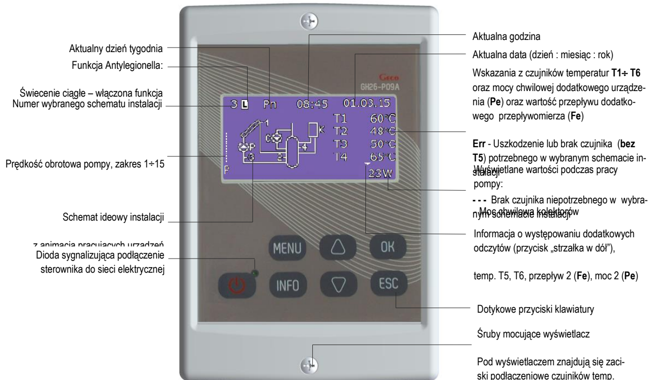
Rys. 2. Opis podstawowego ekranu na wyświetlaczu LCD
